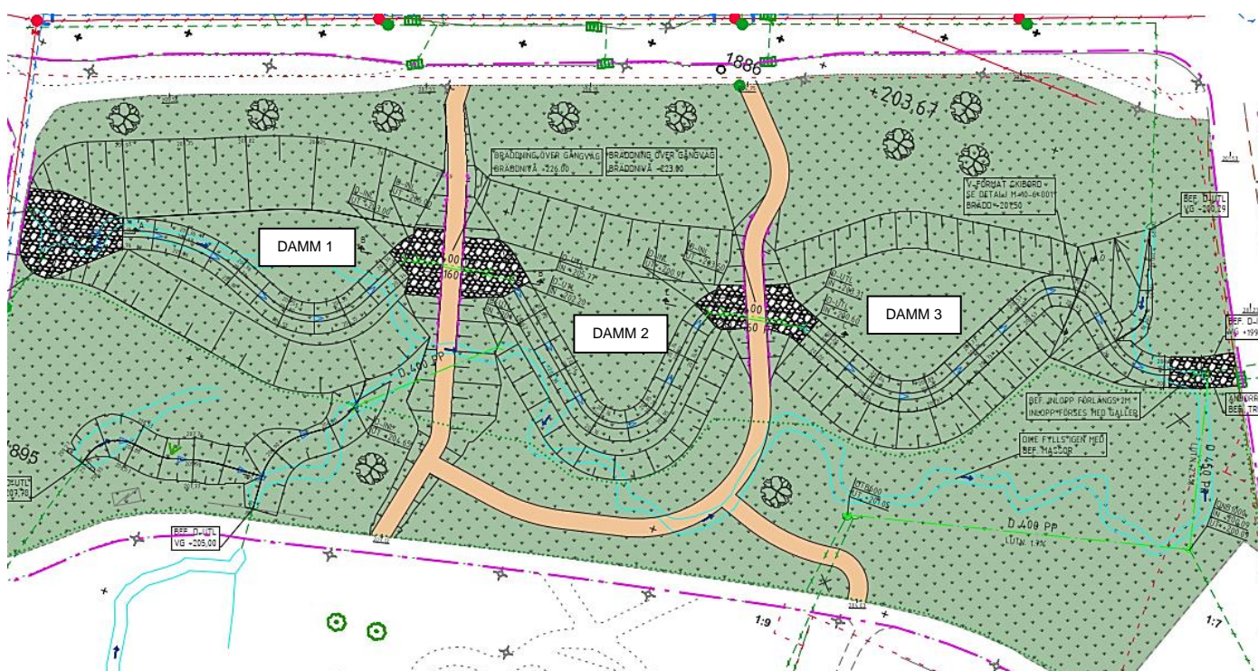
Figur 5. Planerade åtgärder. Dammarna ses mellan de streckade områdena. Bäckens nya dragning passerar söder om dammarna, strömningsriktningen markeras med mörkblå pilar.
